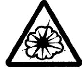
Danger!: Blast Hazard
